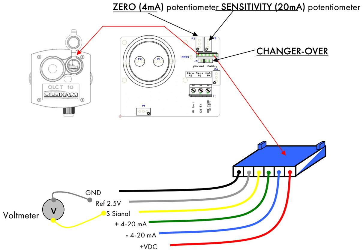
**MAINTENANCE CONNECTOR WIRES:**
