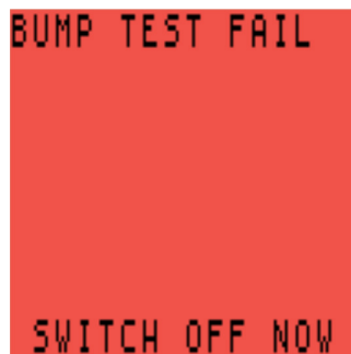
Figura 6-8: Prueba funcional incorrecta - Apague el detector
