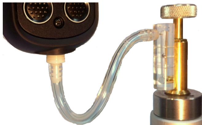
Figura 6-4: Equipo para pruebas funcionales
