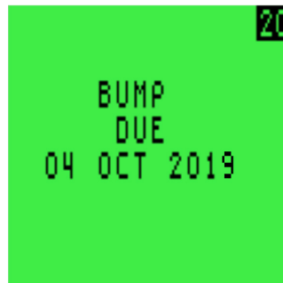
Figura 3-7: Fecha de vencimiento de la prueba funcional
