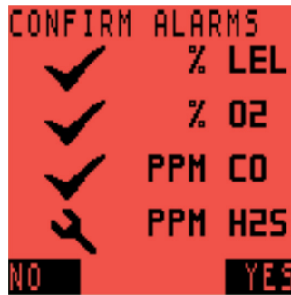
Figura 6-7: Confirmar alarmas - Incorrecto
